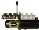
Montaggio diretto delle elettrovalvole HDF\* e dei moduli AMF
