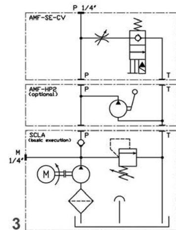
A richiesta, prima di ogni blocco valvole, può essere inserita una pompa a mano **AMF-HP2** da 2cm<sup>3</sup>/colpo.
